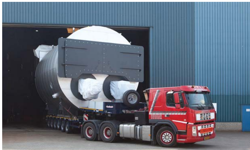
Transport eines Doppelflammrohrkessels für Iggesund Paperboard SA, Workington, Großbritannien
